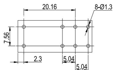
备注: (1) 产品外形尺寸未注尺寸公差, 当外形尺寸 $\leq 1\text{mm}$ 时, 公差为 $\pm 0.2\text{mm}$ ; 当外形尺寸 $1\text{mm} \sim 5\text{mm}$ 时, 公差为 $\pm 0.3\text{mm}$ ; 当外形尺寸 $\geq 5\text{mm}$ 时, 公差为 $\pm 0.5\text{mm}$ 。
