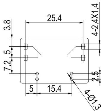
备注: (1) 产品外形尺寸未注尺寸公差, 当外形尺寸 $\leq 1\text{mm}$ 时, 公差为 $\pm 0.2\text{mm}$ ; 当外形尺寸 $1\text{mm} \sim 5\text{mm}$ 时, 公差为 $\pm 0.3\text{mm}$ ; 当外形尺寸 $\geq 5\text{mm}$ 时, 公差为 $\pm 0.5\text{mm}$ 。
