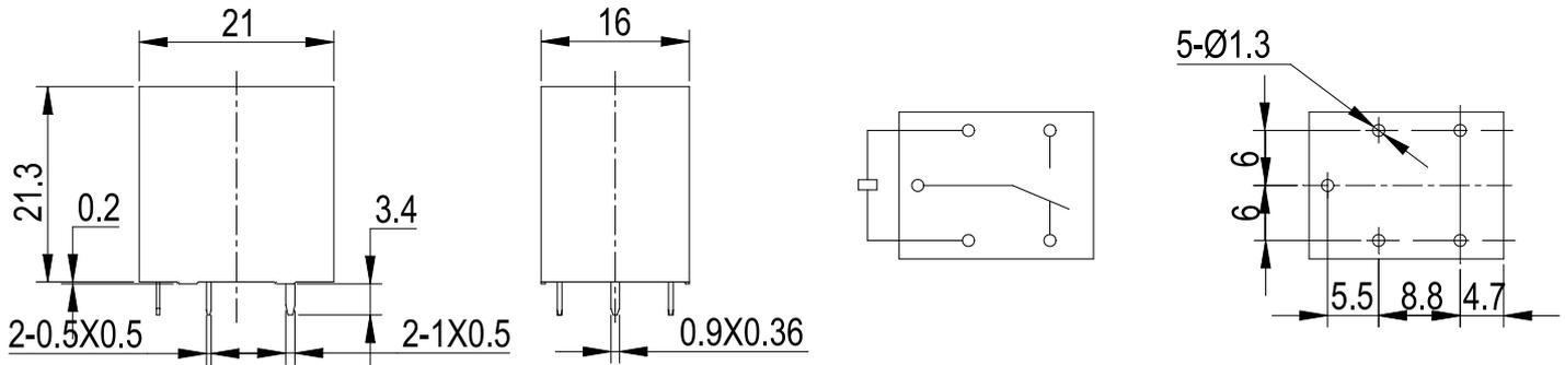
备注: (1) 产品外形尺寸未注尺寸公差, 当外形尺寸 $\leq 1\text{mm}$ 时, 公差为 $\pm 0.2\text{mm}$ ; 当外形尺寸 $1\text{mm} \sim 5\text{mm}$ 时, 公差为 $\pm 0.3\text{mm}$ ; 当外形尺寸 $\geq 5\text{mm}$ 时, 公差为 $\pm 0.5\text{mm}$ 。
